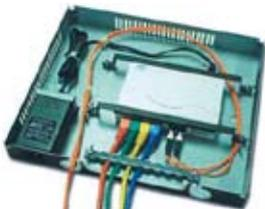
Gehäuse für Mini-Switch montiert
